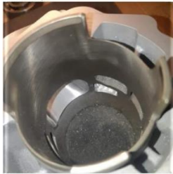
80cc 2win Ripper Porting Hier einmal den Auslass auf 194° angehoben. Die Stömer hatten ab werk schon 132°, mussten also nicht geportet werden.
