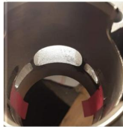
Por causa disto, agora temos transbordações que estão exatamente a 130o sem precisar de portá-los! Agora a tomada foi portada para 195o. A tomada esquerda e a do meio estão quase terminadas, a direita ainda é original. Ai o cilindro pode voltar pro cliente
